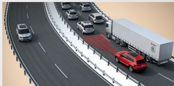
מערכת Front Assist (ניטור מרחק מלפנים)
