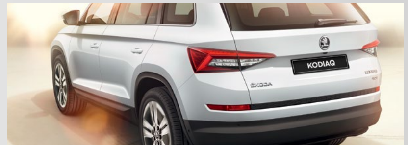
פס כוורת אחורי - מוטיב עיצובי ופונקציונאלי שמטרתו להגן על הפגוש בעת הטענת ציוד
